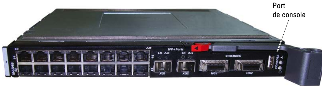
Figure 2. Connexion au port de console
